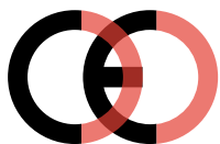
Marcatura CE contraffatta (troppo vicino)
